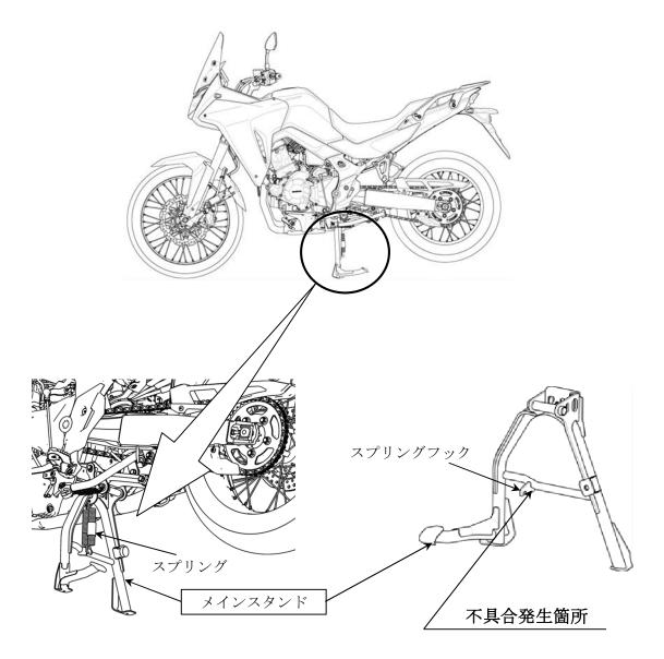
後付け部品として販売したメインスタンドにおいて、スプリングフックの溶接条件が不適切なため、溶接部の強度が不足しているものがある。そのため、メインスタンドを立てる際に溶接部が破断した場合は、スプリングフックが外れて車両が倒れるおそれがある。また、走行中に溶接部が破断した場合はメインスタンドが路面に接地し、最悪の場合、転倒するおそれがある。
