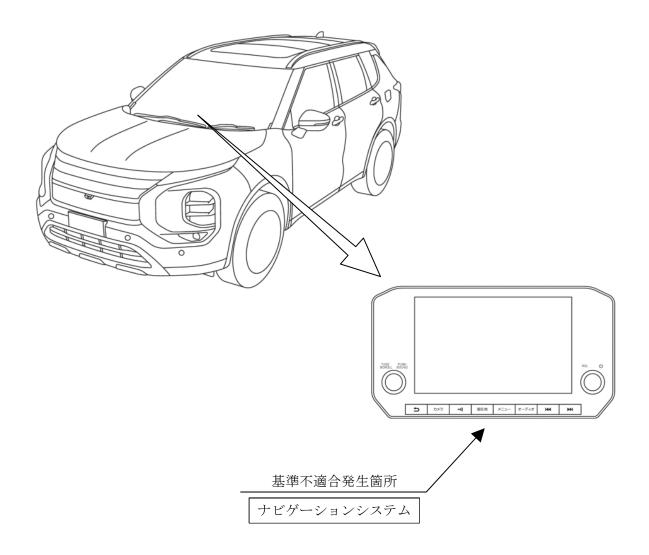
ナビゲーションシステムにおいて、制御プログラムの設定不備により、起動時にシステム内の情報処理が完了せず、再起動を繰り返す場合がある。そのため、液晶画面に直前直左確認用のカメラ映像が表示されず、保安基準第44条(後写鏡等の基準)に適合しなくなるおそれがある。
