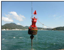
<灯浮標の引揚げ>
