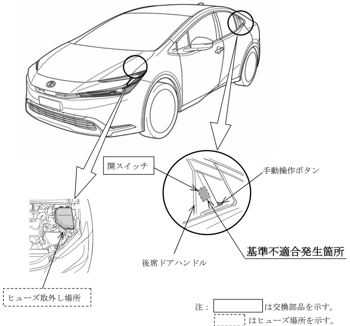
後席ドアハンドルの開スイッチの防水性能が不十分なため、洗車等で多量の水がかかるとスイッチ内部に浸入することがある。そのため、そのままの状態で使用を続けると、スイッチ内部の回路が短絡して作動し、最悪の場合、走行中に後席ドアが開くおそれがある。
