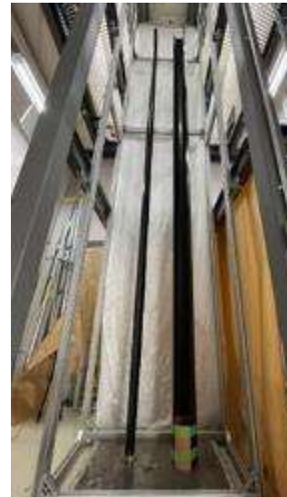
実機1/2サイズCFRP部材 改良型SAP展開機構BBM
