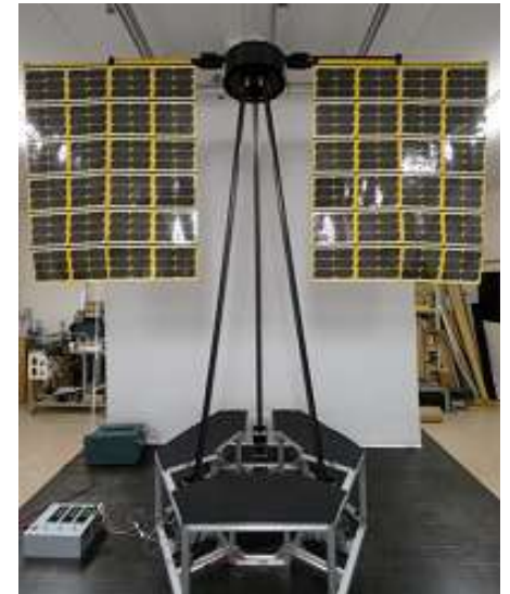
実機1/2サイズCFRP部材 改良型SAP展開機構BBM
