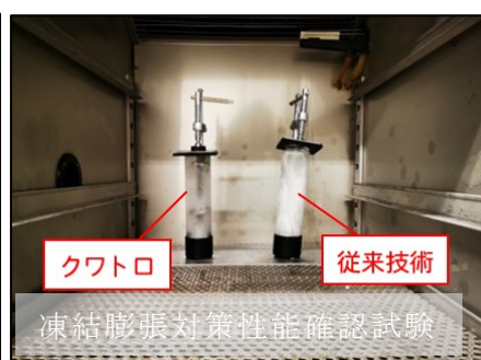
写真-1 性能確認試験（飛来塩分対策・振動対策・凍結膨張対策）
