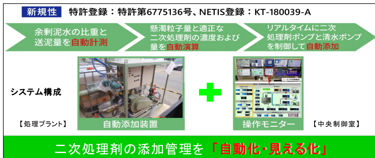
図-2 泥水二次処理剤自動添加システム ※1: 第23回国土技術開発賞 創意開発技術賞 ※2: 令和4年度土木学会環境賞
