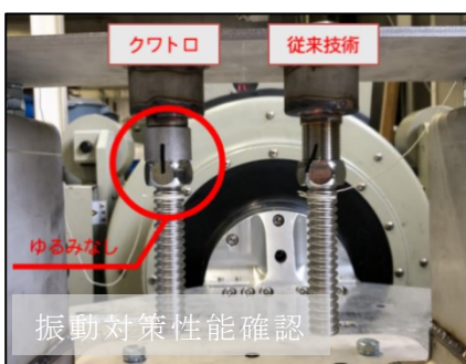
写真-1 性能確認試験（飛来塩分対策・振動対策・凍結膨張対策）
