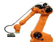
ピッキングロボット
