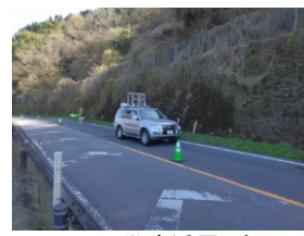
MMS※1を活用した 斜面・のり面点検
