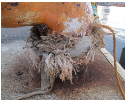
写真7：劣悪な係留ロープ
