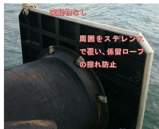
写真10：係留ロープが絡みにくい対策
