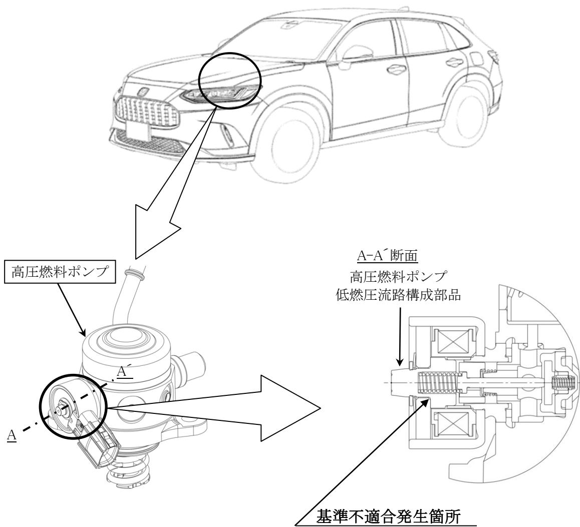
ハイブリッド車において、高压燃料ポンプ構成部品の加工工程が不適切なため、加工時の金属粉が当該ポンプの構成部品と加工治具の間に噛み込むものがある。そのため、加工部端面に亀裂が発生し、そのまま使用を続けるとポンプ作動時の振動で亀裂が貫通し、燃料漏れに至るおそれがある。
