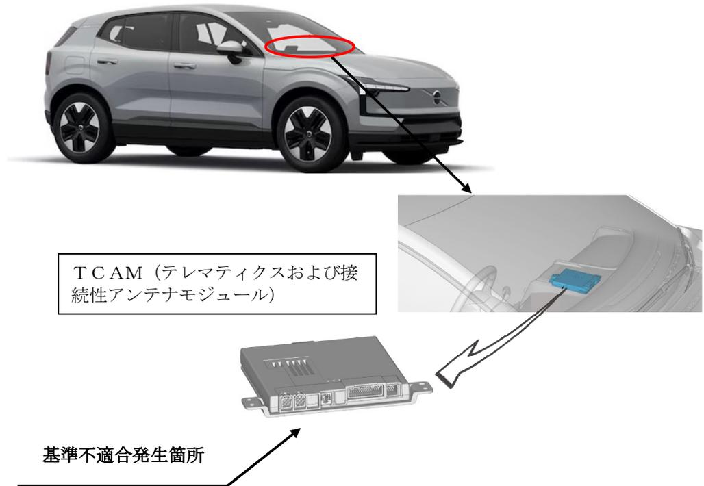
TCAM (テレマティクスおよび接続性アンテナモジュール) において、制御プログラムが不適切なため、モバイルネットワーク回線に接続することができない。そのため、通信ができず、保安基準第 43 条の 8 (事故自動緊急通報装置の基準) に適合しない。
