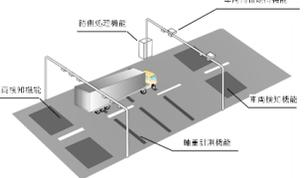
(左)現地取締 (右)自動重量計測装置による取締イメージ
