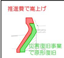
対策例：被災した護岸を災害復旧事業による原形復旧にあわせて、推進費により嵩上げを実施。
