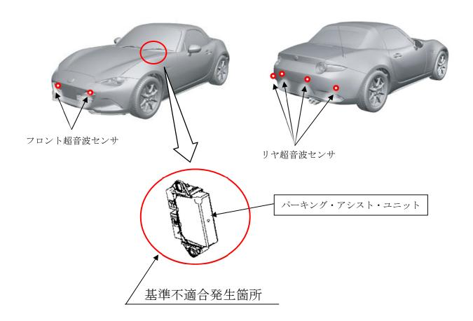
パーキング・アシスト・ユニットにおいて、ホイールの車輪速センサからの信号処理が不適切なため、後進時に超音波センサが検出した障害物との距離と、車輪速センサからの信号で算出した移動距離に不整合が出ることがある。そのため、障害物の位置と距離を知らせるパーキングセンサインジケータとブザーが正しく作動しないおそれがある。また、スマート・ブレーキ・サポートの後方検知機能\*1 も作動しないおそれがある。さらに、自動変速機を搭載した車両については、AT誤発進抑制制御(前進時/後進時)\*2 も作動しないおそれがある。
