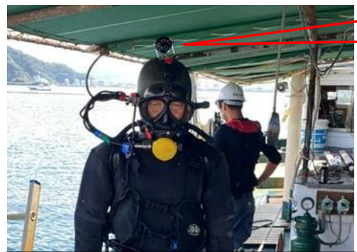
水中カメラを頭部に取付け作業の効率化を実現
