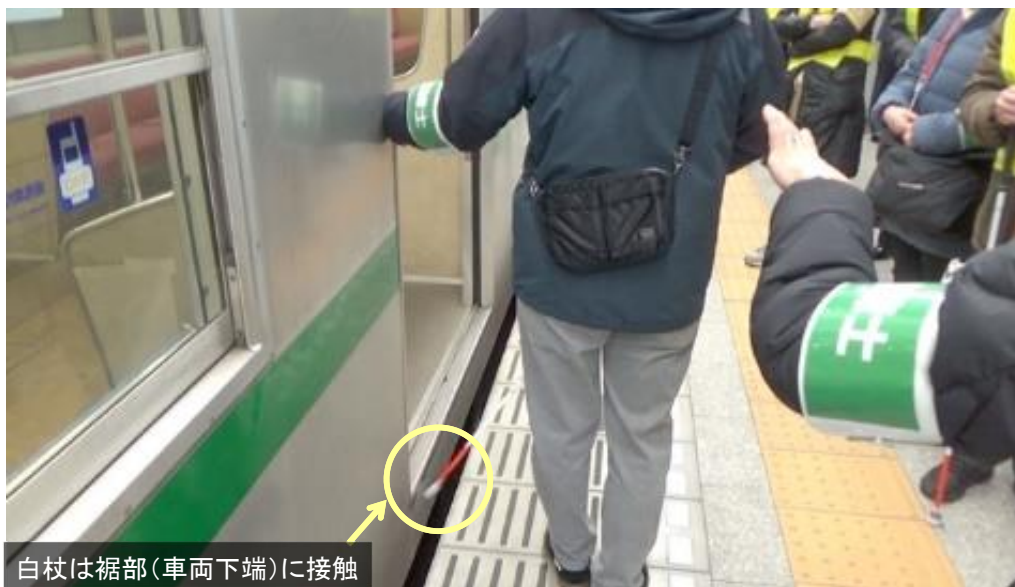
白杖は裾部(車両下端)には接触しないが、前方に出すと妻部(連結面)に接触
