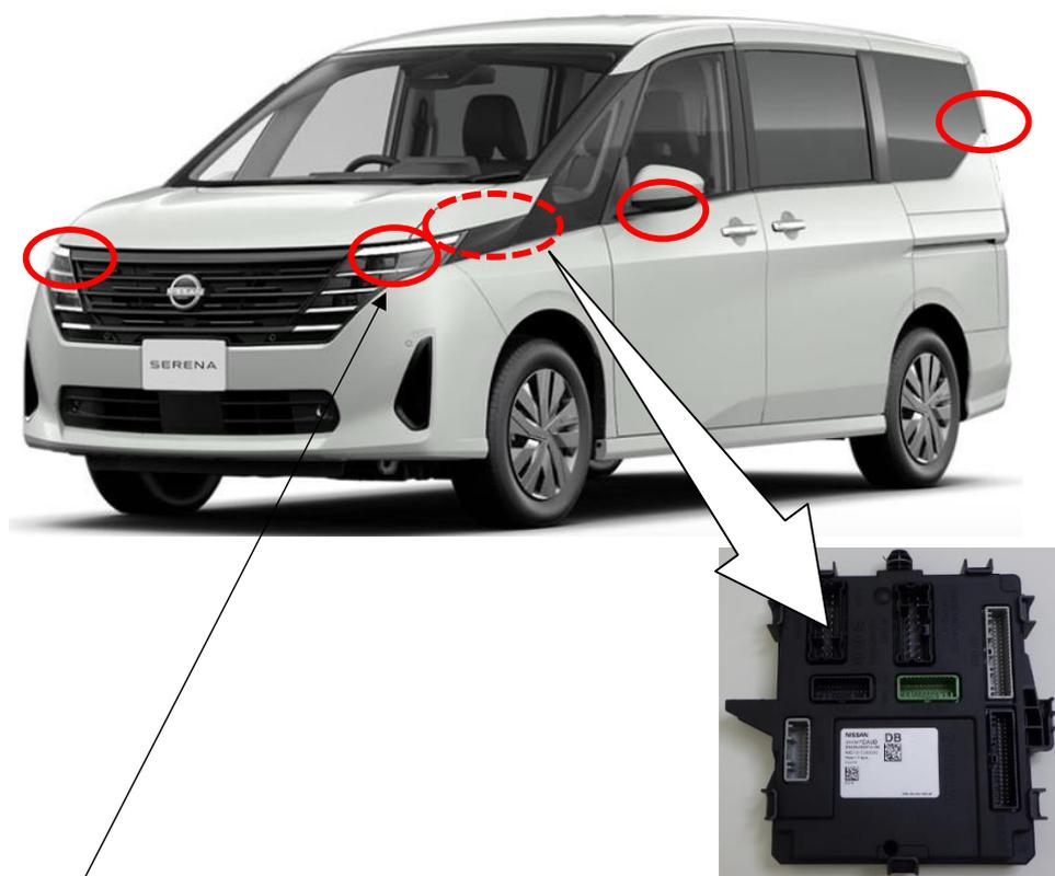
電気装置（ボディコントロールモジュール）
