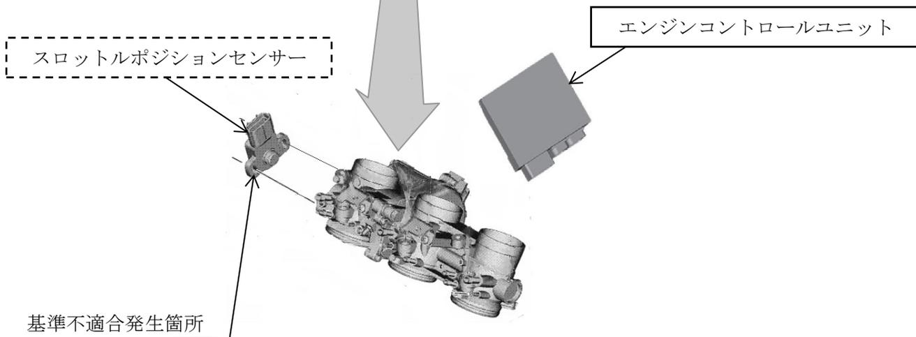
エンジンコントロールユニットのプログラムが不適切なため、スロットルポジションセンサーの接点部が微小な動きを繰り返すことで早期に摩耗し、摩耗粉が堆積することがある。そのため、接点部に堆積した摩耗粉により正しいスロットル開度を認識できず、エンジン回転数の変動が起こること
