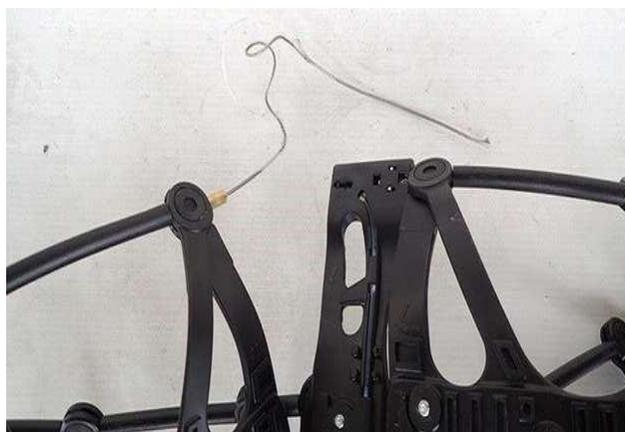
製品取付けの際、巻き取りモードにしていない、または、手繰り寄せ不足により、製品がタイヤから車両内側に大きくずれることで車両に引っかかり破損する。
