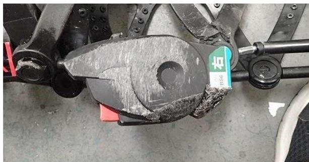
ワイヤ巻き取りが完了前に高速で走行することにより、地面にリール本体が繰り返し打ち付けられることでリール本体が破損する。
