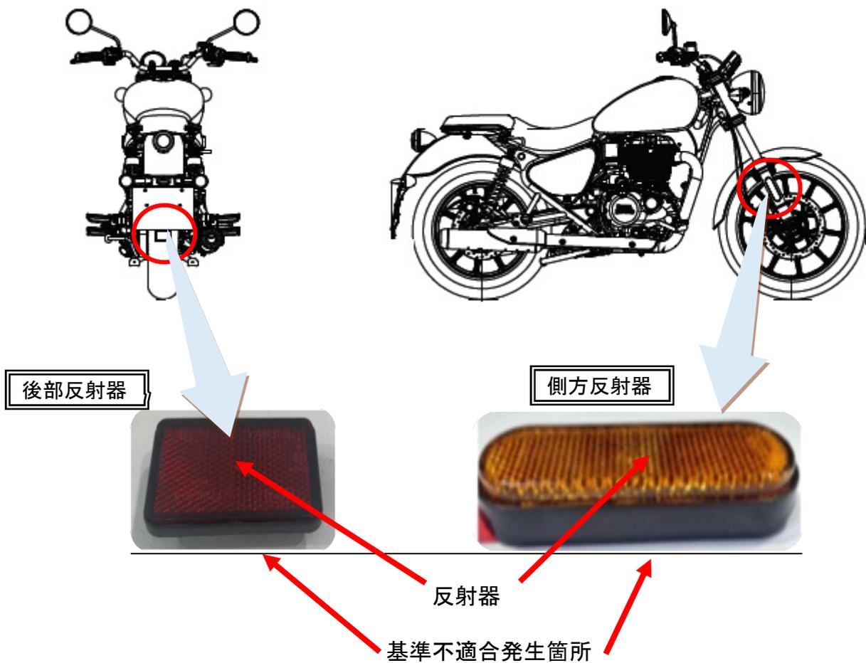
側方反射器及び後部反射器において、機器管理が不適切なため、反射器内部の表面が適切に成型されていないものがある。そのため、反射光が散乱し、保安基準に適合しないおそれがある。
