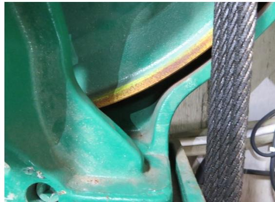
写真 10 事故後のブレーキドラム下隙間
