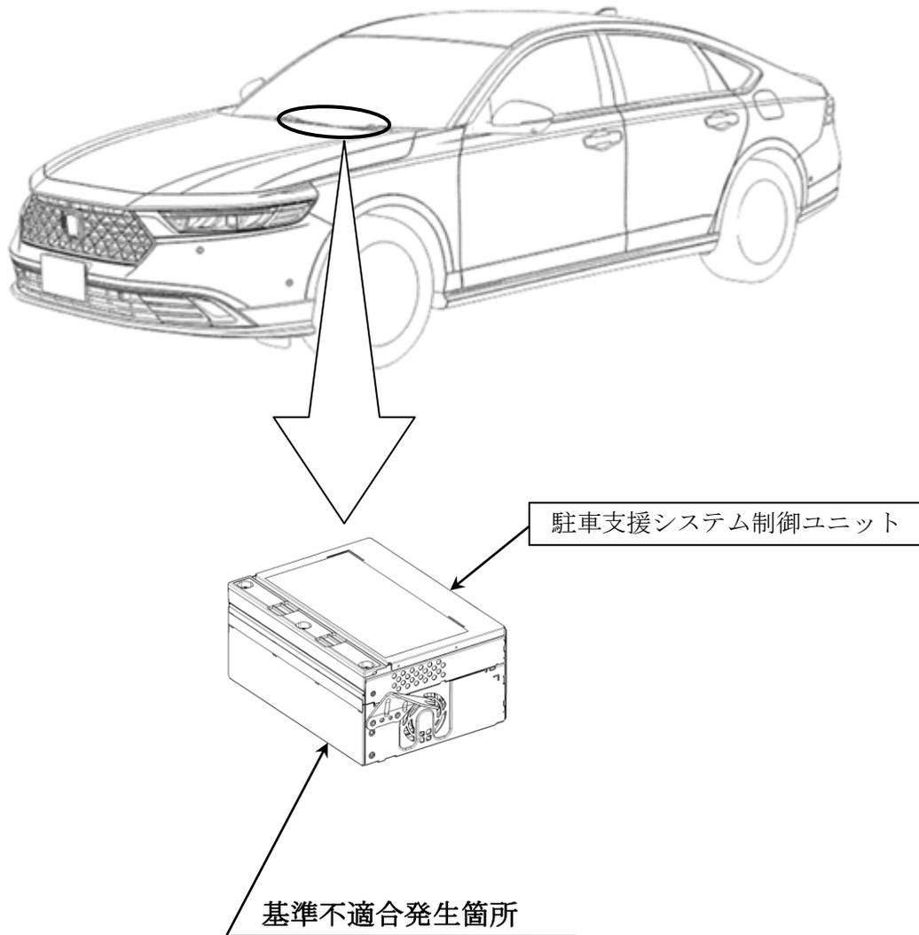
駐車支援システムであるパーキングパイロット※の制御プログラムが不適切なため、ディスプレイにパスワード入力画面を表示したまま当該機能を使用すると、駐車時または出庫時に操舵支援が終了した際、警告音が吹鳴しない。そのため、保安基準に適合しない。
