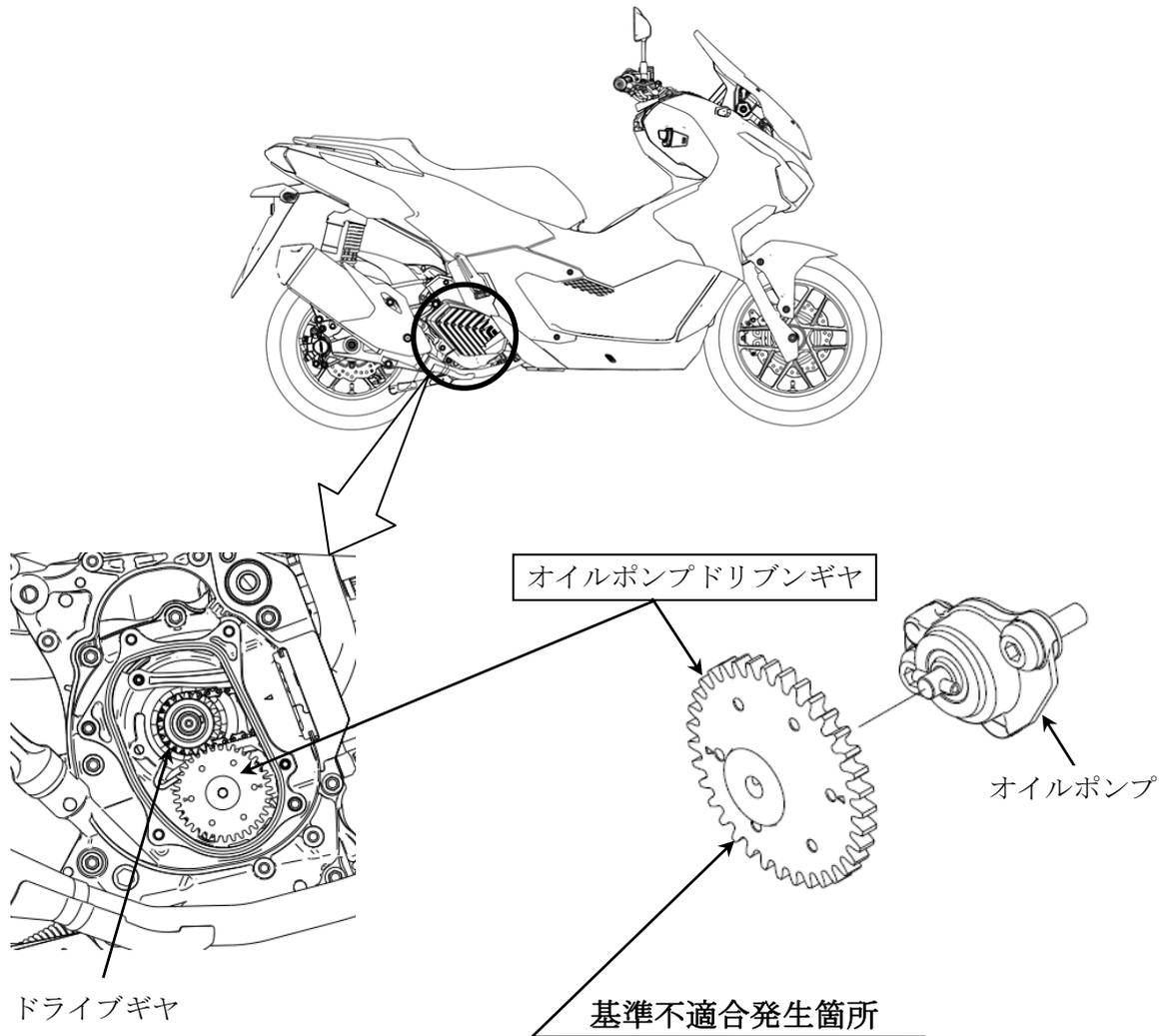
原動機において、オイルポンプドリブンギヤの材料および成型が不適切なため、ドリブンギヤが傾くものがある。また、ドライブギヤの歯面が粗いものがある。そのため、噛み合う際にドリブンギヤが摩耗して異音が発生し、そのまま使用を続けると、ギヤが破損し油圧が低下して、最悪の場合、走行中にエンジンが停止して走行不能となるおそれがある。
