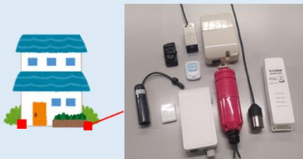
実証実験に用いている浸水センサ
