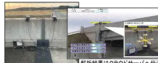
解析結果はクラウドサーバへ伝送 (PC・スマートフォンで閲覧可)
