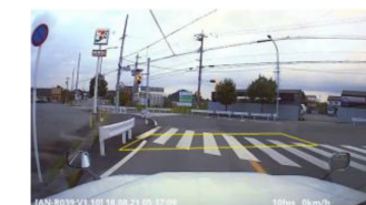
ドライブレコーダーで取得した 画像による区画線の摩耗判定
