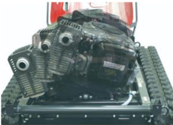
写真－３ エンジン等を傾斜面山側へ向け 自動傾動（左右に最大２０度）
