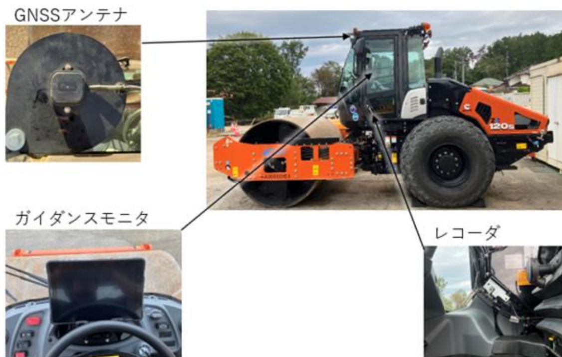
図－3 転圧管理システム構成
