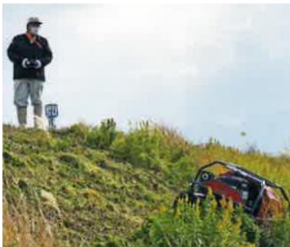
写真－５ 作業員は安全な場所から遠隔操作による除草作業が可能
