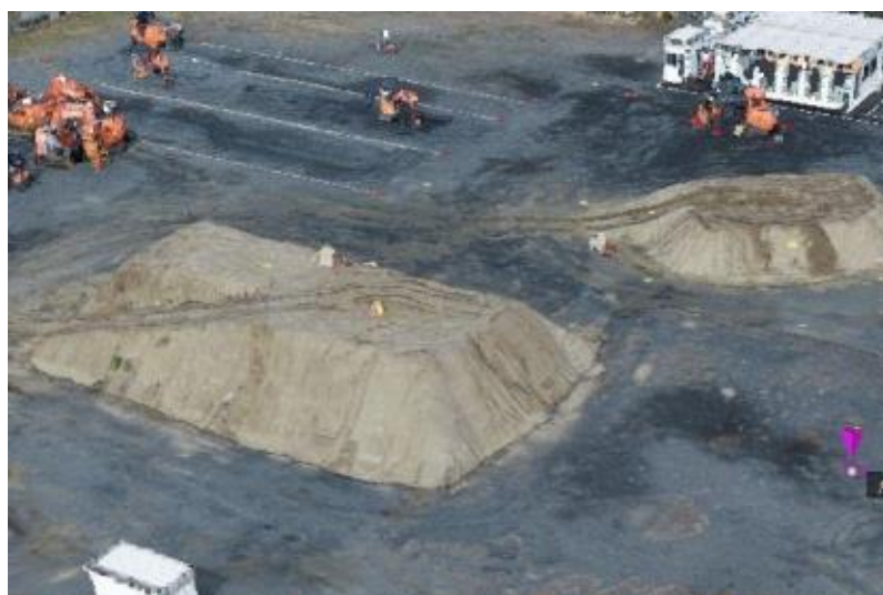
図－３ 本技術で生成した 3 次元点群データ
