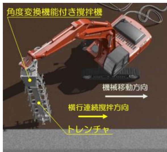
図一 2 角度変換機能付き攪拌機
