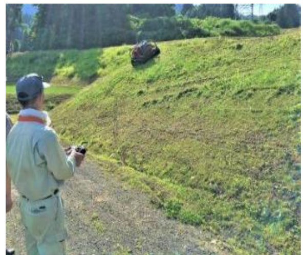
写真－５ 作業員は安全な場所から遠隔操作による除草作業が可能
