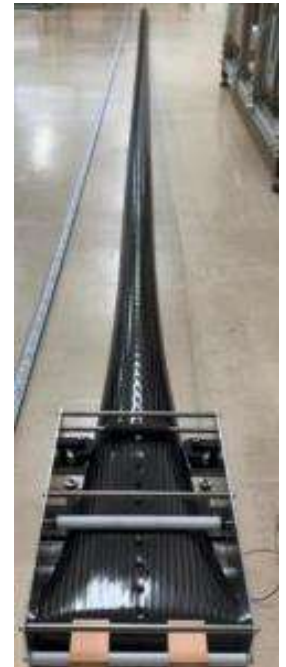
実機相当CFRP展開試験
