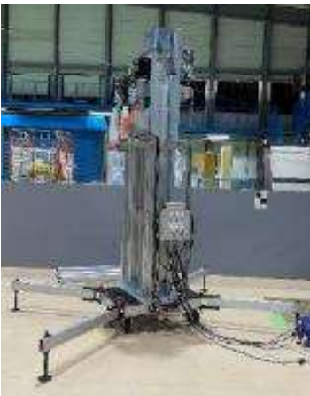
リフトアップ式支柱組立装置
