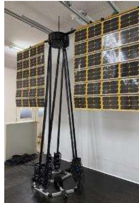
支柱構造改良BBM試験
