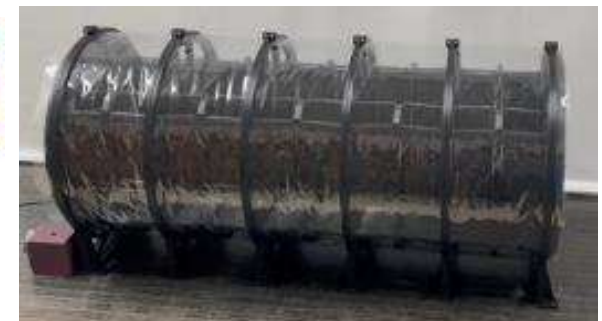
内部展開機構の動作確認BBM試験
