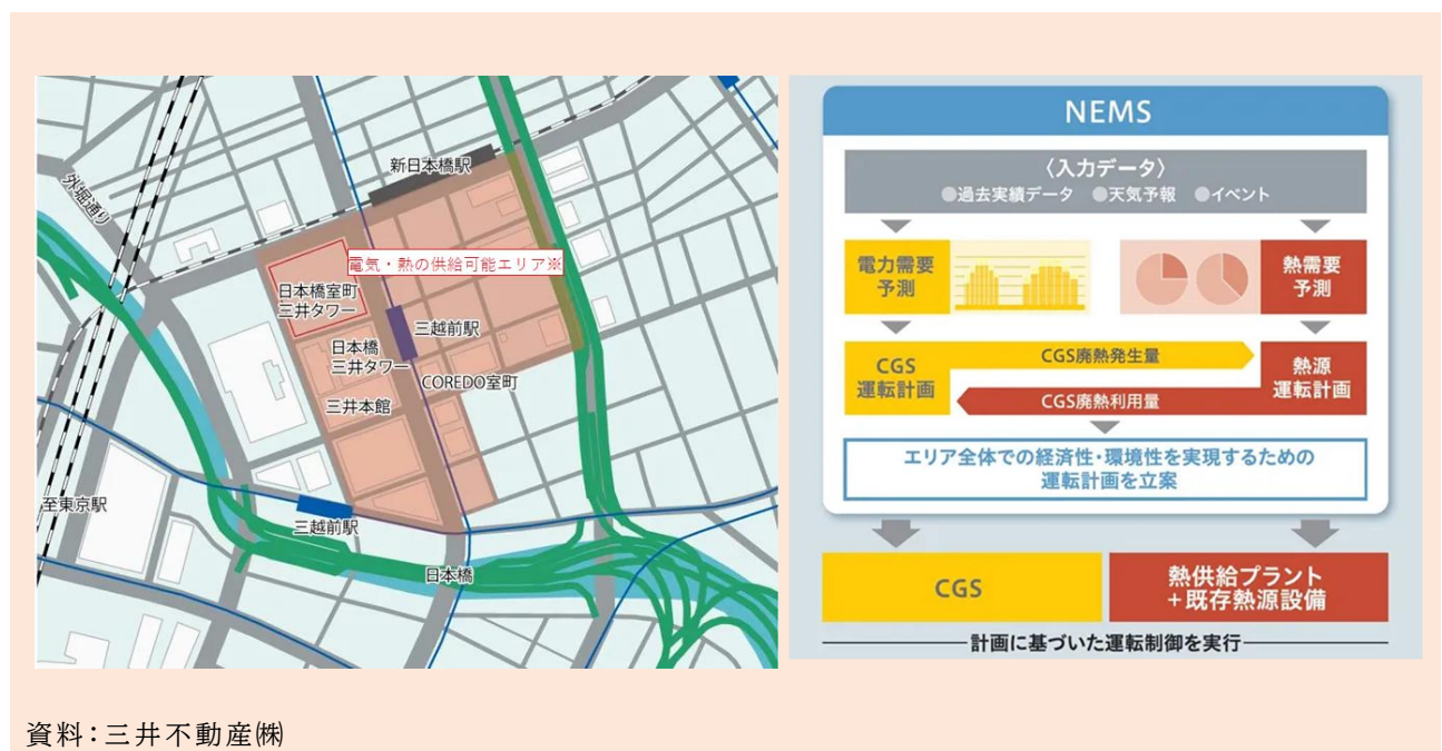
図表1-7-8 日本橋スマートエネルギープロジェクト
