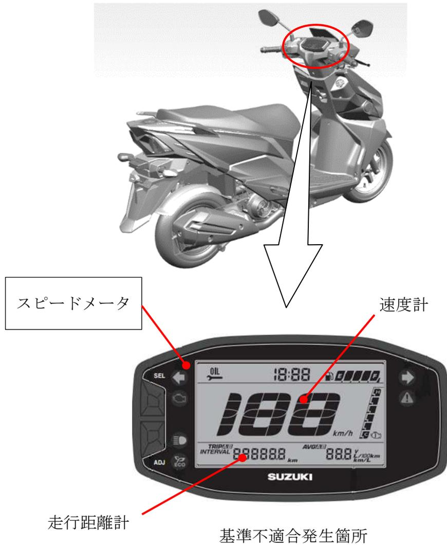
速度計（スピードメータ）および走行距離計（オドメータ）において、ケースの防水性能が不足しているため、雨水等の水分が内部に浸入することがある。そのため、そのまま使用を続けると、基板が腐食して速度および走行距離を表示できなくなるおそれがある。
