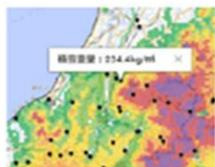
1km格子の積雪荷重(kg/m<sup>3</sup>)の表示例
