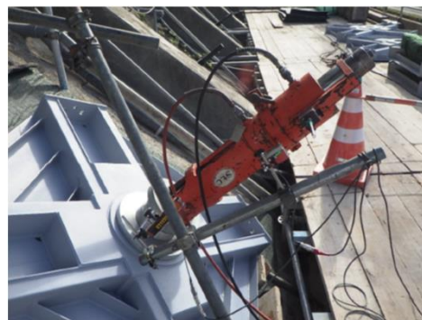
リフトオフ試験※による既設アンカーの残存緊張力の確認
