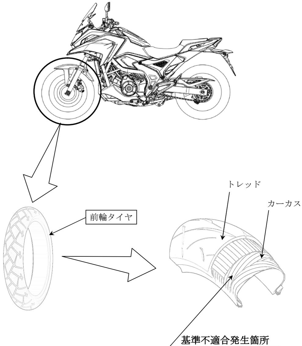
前輪タイヤの製造工程が不適切なため、タイヤ内部のカーカスが適正な角度で成形されていないものがある。そのため、高速走行等の高負荷の走行を続けると、カーカスに応力が集中し断線して、タイヤ内面に亀裂が生じ、タイヤトレッド部が変形して車体が振動し、走行安定性を損なうおそれがある。
