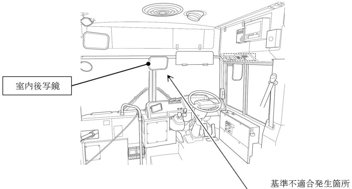
室内後写鏡（凸面鏡）において、製造工程における寸法管理が不適切なため、鏡面幅が小さいものがある。そのため、ワンマンバスの構造要件に適合しないおそれがある。
