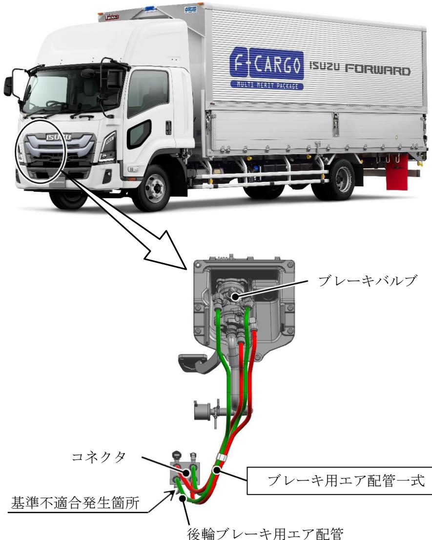
制動装置において、ブレーキバルブとコネクタの搭載位置が左右にオフセットしていることに加え、後輪ブレーキ用エア配管（ナイロンチューブ）の形状が不適切なため、キャブの揺動によりナイロンチューブがコネクタから抜けることがある。そのため、後輪ブレーキへのエアの供給が絶たれ、後輪ブレーキが効かなくなるおそれがある。
