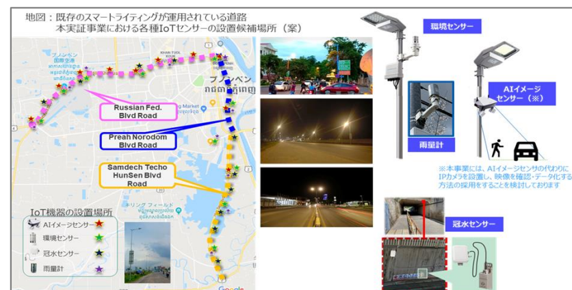
図 2: 既存のスマートライティングが運用されているプノンペン都の道路と本実証事業における各種IoTセンサーの設置候補場所および設置イメージ図（案）
