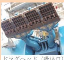
ドラグヘッド(吸込口)で土砂を吸込む
