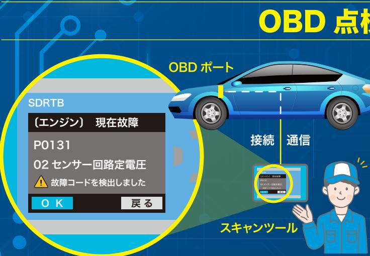
「スキャンツール」を OBD ポートに接続し、「OBD」が記録している、各種装置の故障の有無や作動状況（故障コード）を読み出します。これにより、装置が正常に作動しているかを確認することを、「OBD 点検」と呼んでいます。
