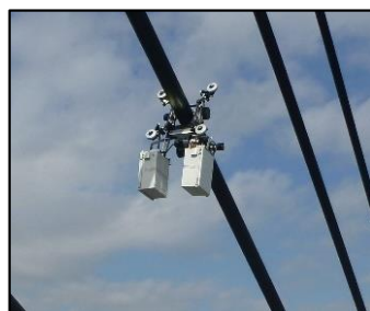
撮影画像 4台のビデオカメラで 斜材の全周を撮影
