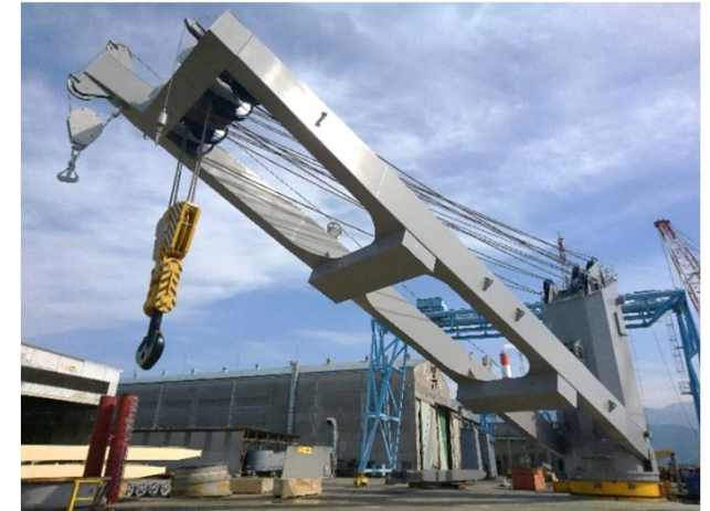
500tonヘビーリフトクレーン
