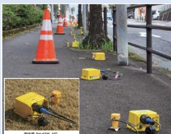
現地ではケーブルレスの測定器を並べて振動を観測します
