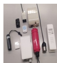
実証実験中の浸水センサ及び表示システム
