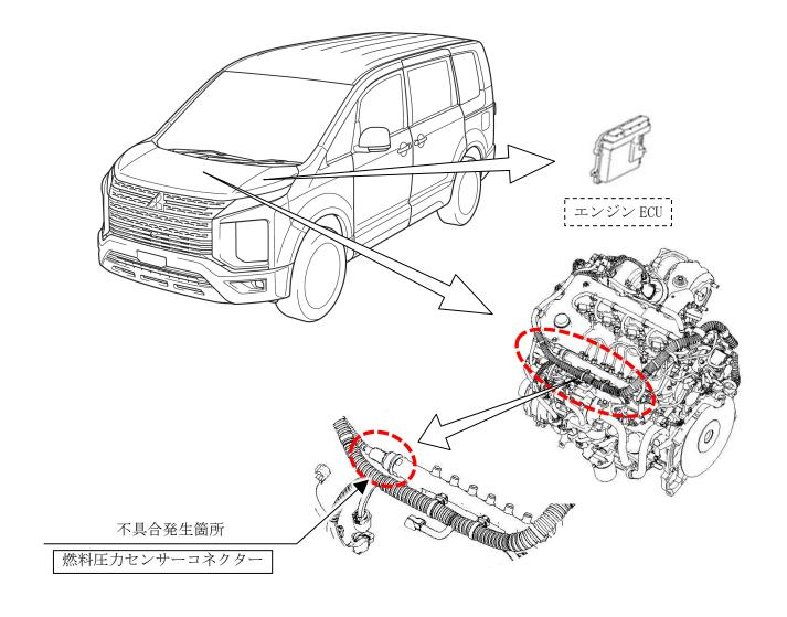
燃料圧力センサーのコネクターにおいて、エンジンルームへの高圧洗浄などによりコネクター内に水 分が浸入することがある。そのため、燃料圧力センサーに異常が生じて燃料噴射量が増加することで エンジン破損に至るおそれがある。
