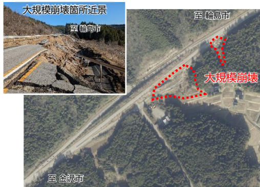
被災直後 (本線・金沢方面オフランプ大規模崩壊)
