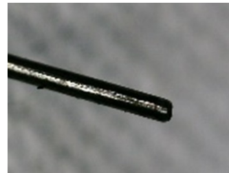
内層素線断面拡大 絞り断面(引張破断)
