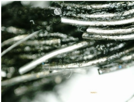
外層素線断面 平面(疲労破断)
