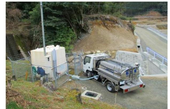
分散型システムの例(給水車による運搬送水)
