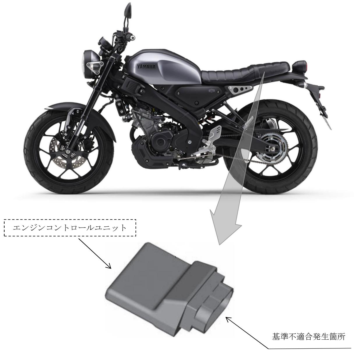
車載式故障診断装置において、エンジンコントロールユニットのプログラム検討が不十分なため、外部診断機（スキャンツール）にエンジン停止時の負荷計算値が正しく表示されない。そのため、保安基準に適合しない。
