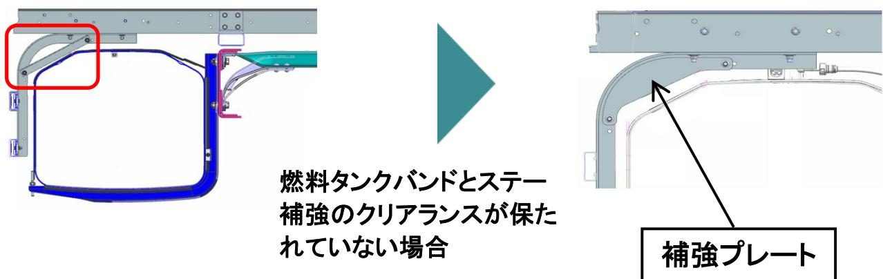
サイドガード(巻込防止装置)において、設計検討が不十分なため、サイドガードステーの補強部が燃料タンクを固定する燃料タンクバンドに近接しているものがある。そのため、走行中の車両揺動によりサイドガードステー補強部と燃料タンクバンドが干渉し、最悪の場合、燃料タンクバンドが破損し、燃料タンクが脱落して他の交通の妨げになるおそれがある。
