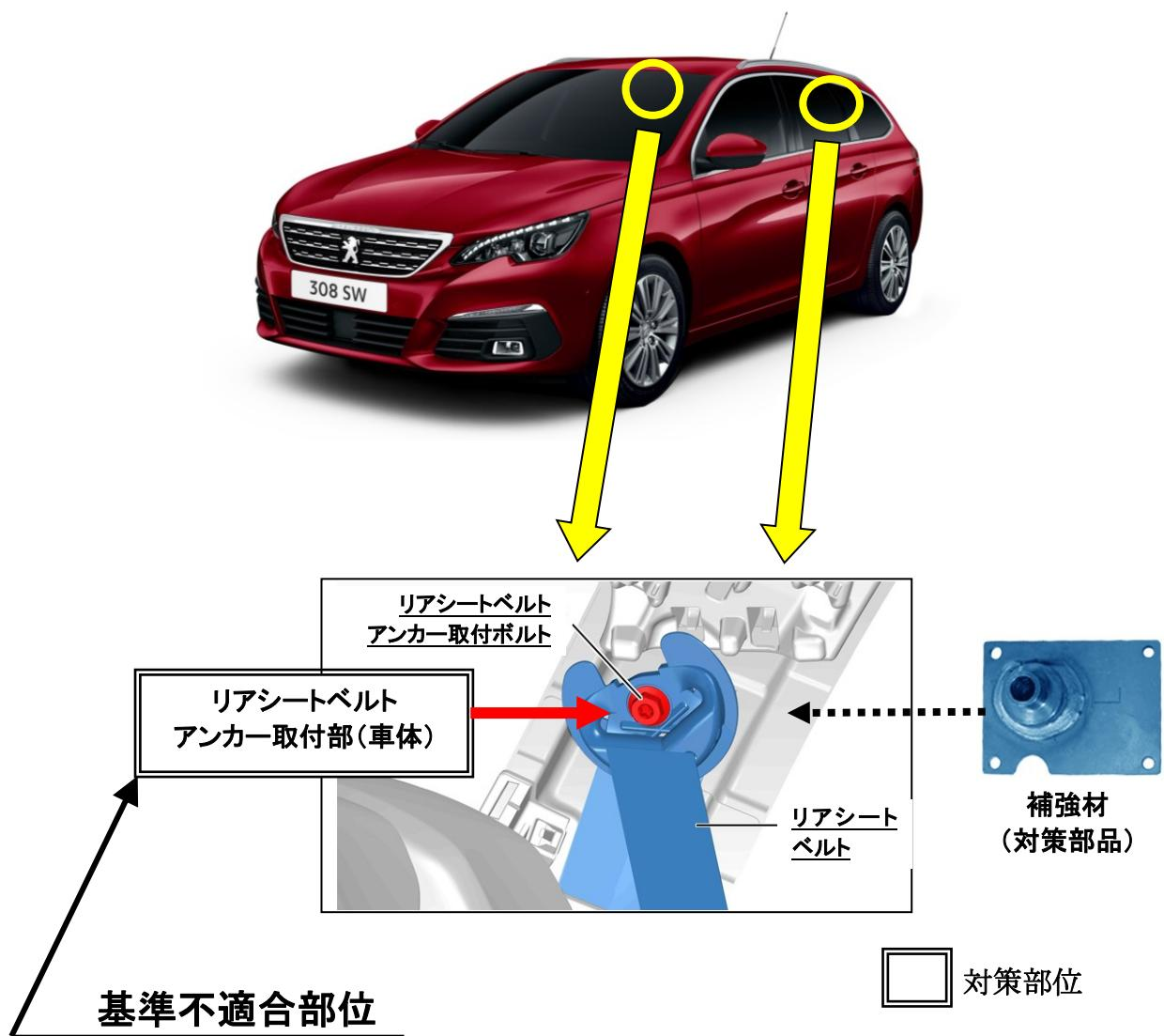
リアシートベルトアンカーにおいて、設計検討が不十分なため、取付部の強度が不足しているものがある。そのため、車両衝突時に荷重がかかると、リアシートベルトアンカーが外れ、乗員を適切に拘束できず、保安基準に適合しないおそれがある。
