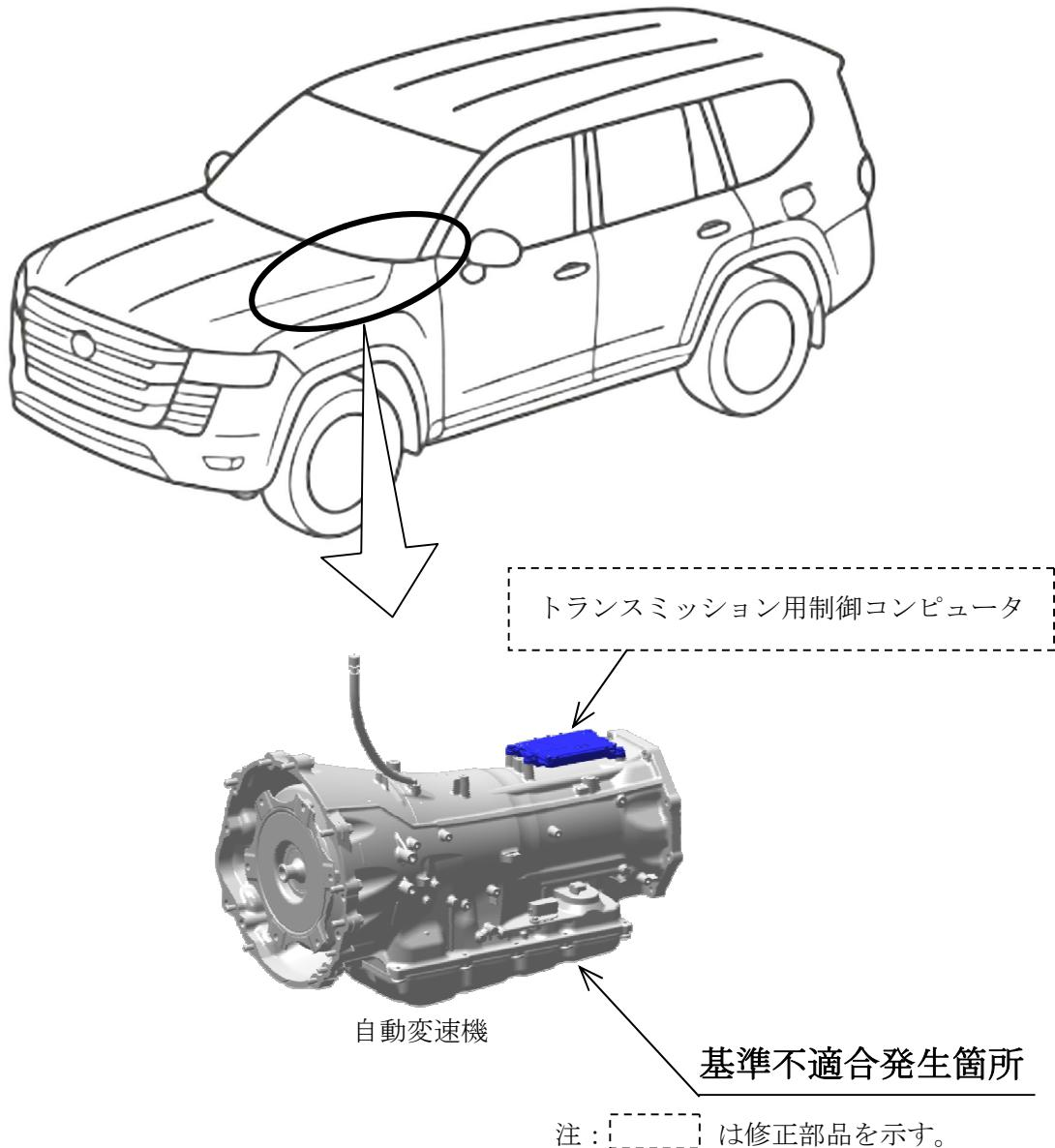
自動変速機（トランスミッション）において、制御プログラムの検討が不十分なため、故障が生じた際に構成部品の過回転を抑制できないことがある。そのため、トランスミッションが損傷して走行不能となり、最悪の場合、漏れたトランスミッションフルードが排気管に付着して火災に至るおそれがある。
